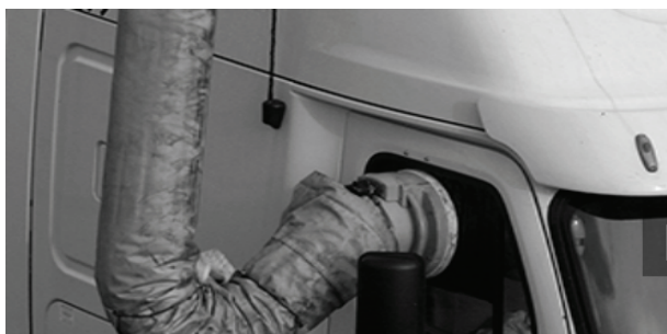
Рис. 4. Оборудование для подключения автопоезда к стационарной климатической установке IdleAir на паркинге, США [7]
